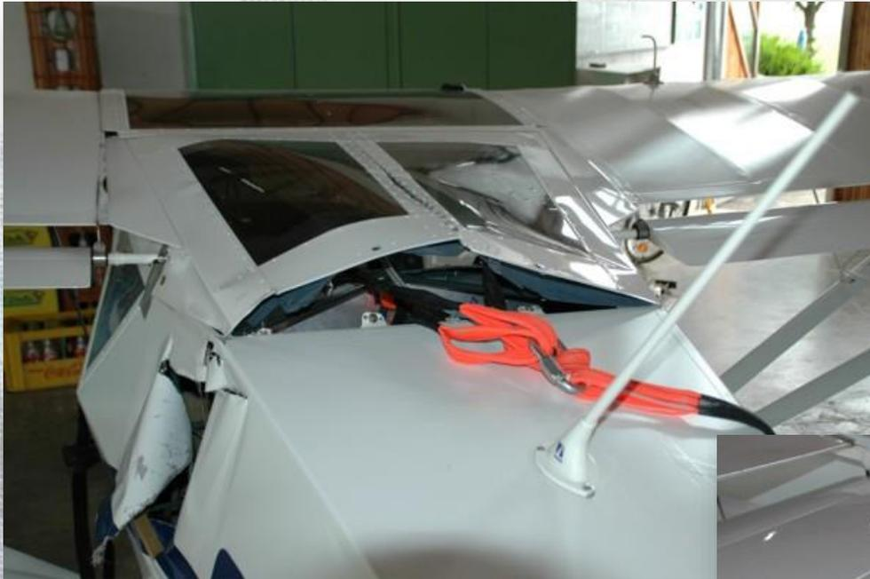
Durch die Unwucht riss das Triebwerk 912 UL aus der Aufhängung und trennte sich von den Vergasern, wodurch es zum Stillstand kam. Das RS wurde betätigt und ausgeschossen.
